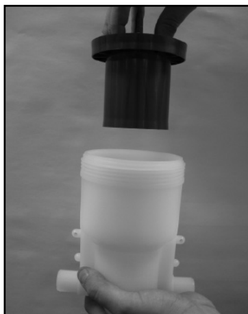
Étape 5 Enlever le piston du moteur du corps de pompe.
