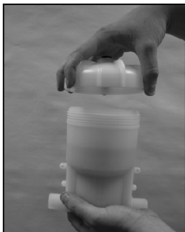
Étape 4 Tenir fermement le corps et dévisser le couvercle. Si le couvercle est trop serré, appuyer sur le bouton de purge au centre du couvercle.
